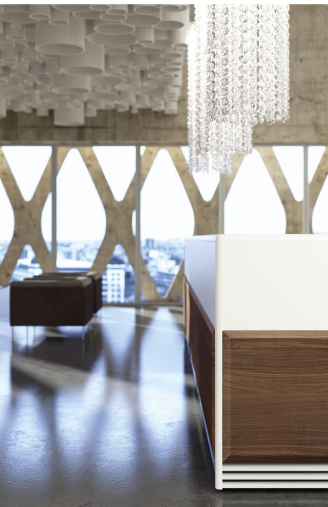
Les panneaux des comptoirs Next sont réalisés avec des profilés en aluminium peint avec des poudres époxy, des plans de travail et des façades en stratifié à haute résistance, tandis que les plinthes sont en aggloméré coloris bois ou uni selon le tableau des couleurs RAL, avec des chanfreins sur les quatre côtés.
