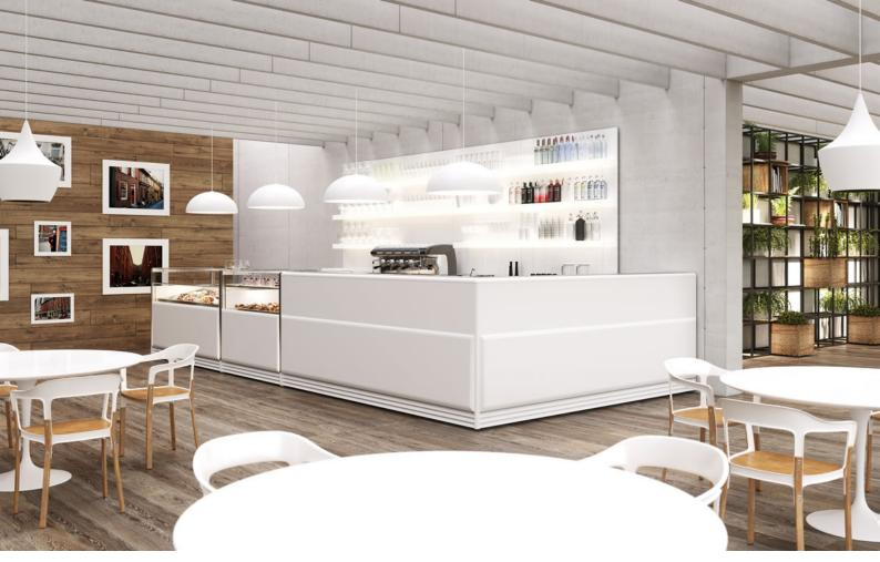
La structure portante des comptoirs, des vitrines et des arrières de comptoir Next est réalisée en acier inox et en aluminium poli. Les portes des bases non réfrigérées peuvent être en acier brillant ou sur demande, assorties au mobilier. Le dessus du comptoir du bar est en stratifié anti-rayures (en option en Corion ou en pierre) tandis que les plans de travail sont en acier inox AISI 304.
