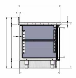
desserte réfrigérée 4 portes groupe à distance + 2 portes dessus granit zone pâtisserie trou sur plan et poubelle basculante plinthe inox
