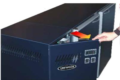
Nouvelle tôle couvre moteur à ouverture latérale, similaire à l'ouverture de la porte, et fermeture à l'aide de 2 aimants. Ce système améliore l'accessibilité à la partie moteur pour faciliter les opérations périodiques de nettoyage du condenseur. De plus nous avons déplacé le thermostat dans la partie supérieure du groupe moteur ou, grâce à une position plus protégé et complètement sans humidité, on peut mieux préserver la durée du thermostat.
