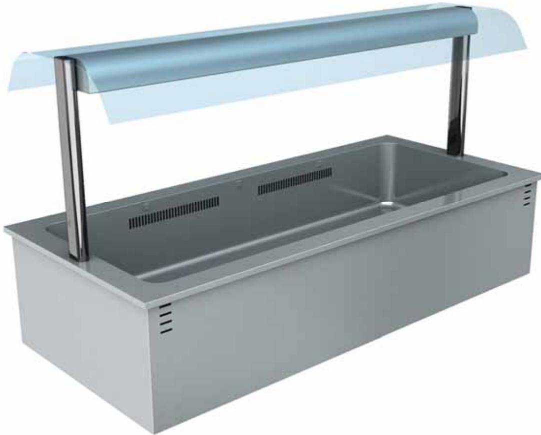
Cuve chauffante ventilée encastrable, avec superstructure. Réalisée en acier inox AISI 304. L'idéal pour présenter des aliments sur assiettes ou plateaux. Réglage de la température de  $+30^{\circ}\text{C} \div + 80^{\circ}\text{C}$  par thermostat. Cuve rayonnée et emboutie, profondeur h. 215 mm. Superstructure réalisée en verre trempé. Éclairage par lampes halogènes. Peut être accessoirisée avec verre frontal pare-haleine. Disponible dans les dimensions 2-3-4-5-6 GN.
