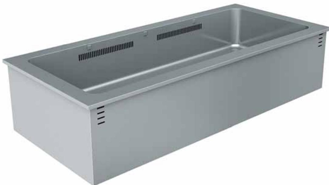
Cuve chauffante ventilée encastrable, réalisée en acier inox AISI 304. L'idéal pour présenter des aliments sur assiettes ou plateaux. Réglage de la température de  $+30^{\circ}\text{C}$  ÷  $+80^{\circ}\text{C}$  par thermostat. Cuve rayonnée et emboutie, profondeur h. 215 mm. Disponible dans les dimensions 2-3-4-5-6 GN.
