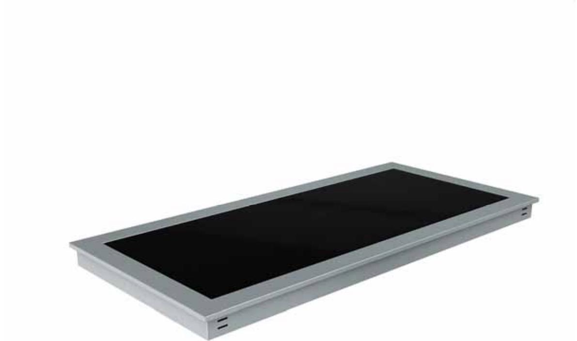
Plan réfrigéré statique encastrable en verre trempé noir, avec groupe logé ou prédisposé pour groupe à distance. L'idéal pour pâtisserie. Réalisé en acier inox AISI 304, isolation par mousse de polyuréthane injectée. Réfrigération statique. Réglage de la température de  $+2^{\circ}\text{C} \div +12^{\circ}\text{C}$  par téléthermostat digital. Disponible dans les dimensions 2-3-4 EN.
