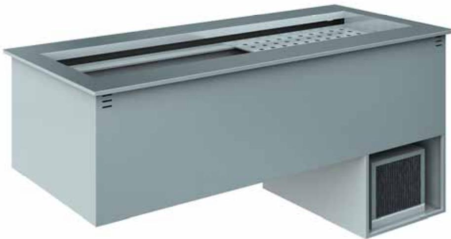
Cuve réfrigérée à basse température encastrable pour l'exposition de bacs à crème glacée, avec groupe logé ou prédisposée pour groupe à distance. Cuve rayonnée en acier inox AISI 304 avec fond incliné. Isolation par mousse de polyuréthane injectée. Réglage de la température de  $-10^{\circ}\text{C} \div -20^{\circ}\text{C}$  par téléthermostat digital. Peut être accessorisée avec plateaux réglables en hauteur pour l'exposition de produits glaciers, coupes de glace, etc...
