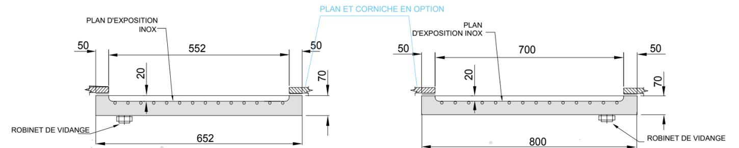
Cuve en acier inox Aisi 304 avec isolation interne en polyuréthane injecté.
