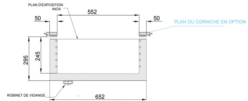
Cuve en acier inox Aisi 304 avec isolation interne en polyuréthane injecté.
