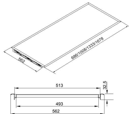
Le plan chaud sec à la cuve isolée, corniche périmétrale en aluminium anodisé, plan d'exposition en verre noir ou en acier inox Aisi 304. Résistance électrique à contact.
