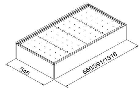
La cuve chaude à bain-marie est réalisée en acier inox Aisi 304 avec angles emboutis dans le fond. Chauffage par résistance électrique sous le fond de la cuve, robinet de vidange sur le fond. Equipée de bacs gastronormes ou d'un plan perforé inox.
