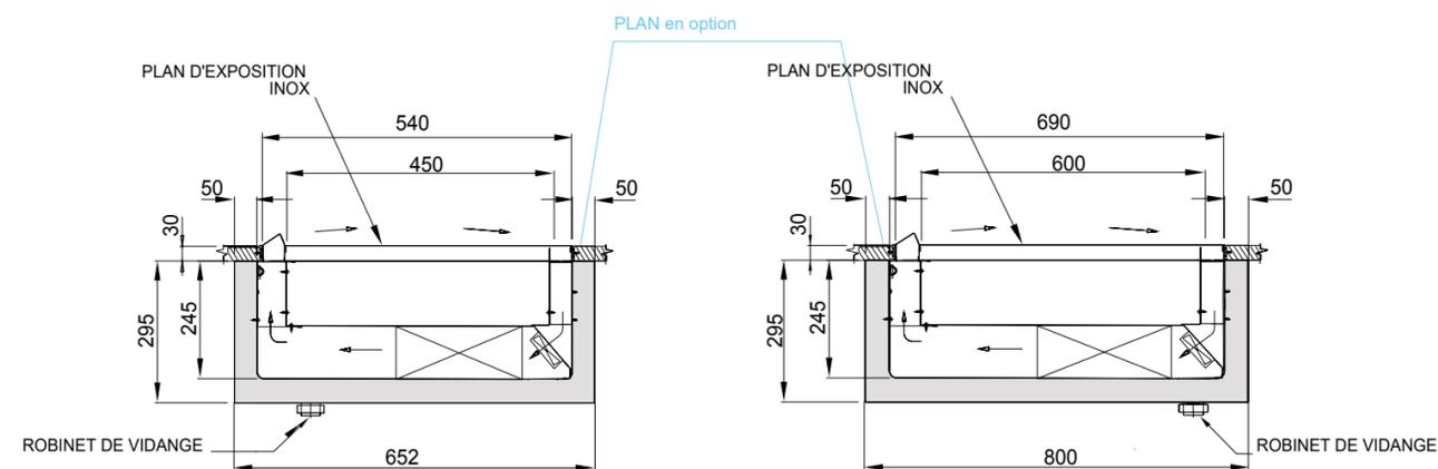
Cuve en acier inox Aisi 304 avec isolation interne en polyuréthane injecté.
