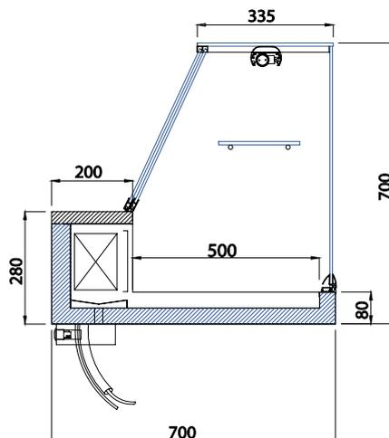
VITRINE REFRIGEREE STATIQUE AVEC SYSTEME DE REFRIGARATION A DETENDEUR R404A, DEGIVRAGE ELECTRONIQUE AVEC ARRÊT SIMPLE. EXPOSITION DANS LA CUVE SUR LE FOND EN ACIER INOXIDABLE. TEMPERATURE D' EXERCICE +4/+8°C. CONTROLE PAR UNITE ELECTRONIQUE. STANDARD LA SORTIE DE TUYAUX DE L'EVAPORATEUR ET DE L'EVACUATION DE L'EAU DE CONDENSATION SUR LA PARTIE DROITE COTE CLIENT.
