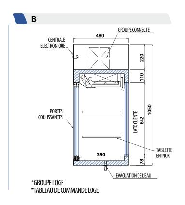
**PROFONDEUR DE LA CUVE: 480 mm**
