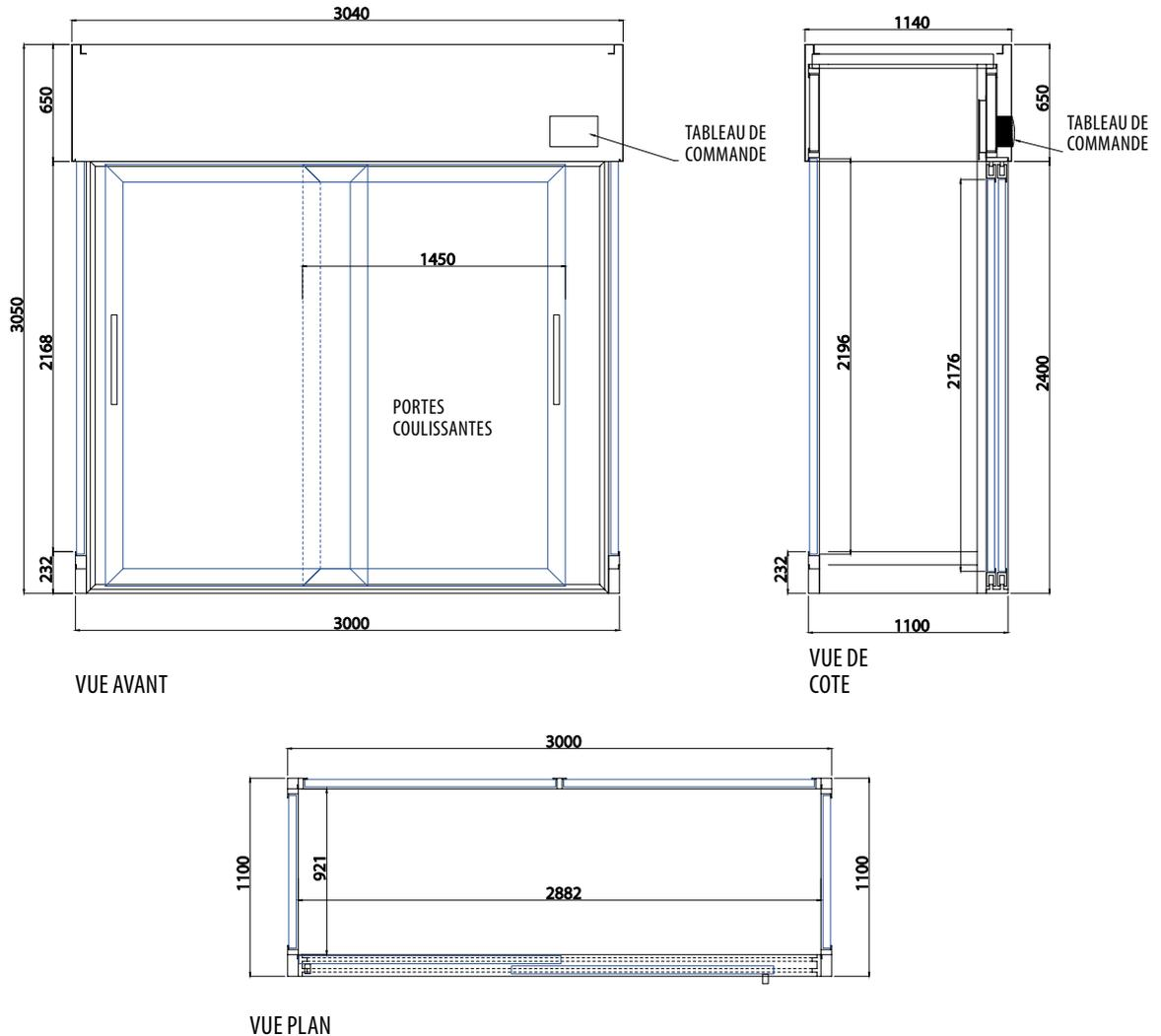
CHAMBRE REFRIGEREE VENTILEE AVEC N. 2 EVAPORATEURS R404A PLACES DANS LA PARTIE SUPERIEURE DE LA CHAMBRE REFRIGEREE, DEGIVRAGE ELECTRIQUE, UNITE DE CONTROLE ELECTRONIQUE, DETENDEUR KVP POUR LA REGULATION DE LA TEMPERATURE D'EVAPORATION, TEMPERATURA D'EXERCICE +2°/+6° C. POSSIBILITE DE REALISER CHAMBRES VISION AVEC LONGUEUR ET PROFONDEUR PERSONNALISEES.
