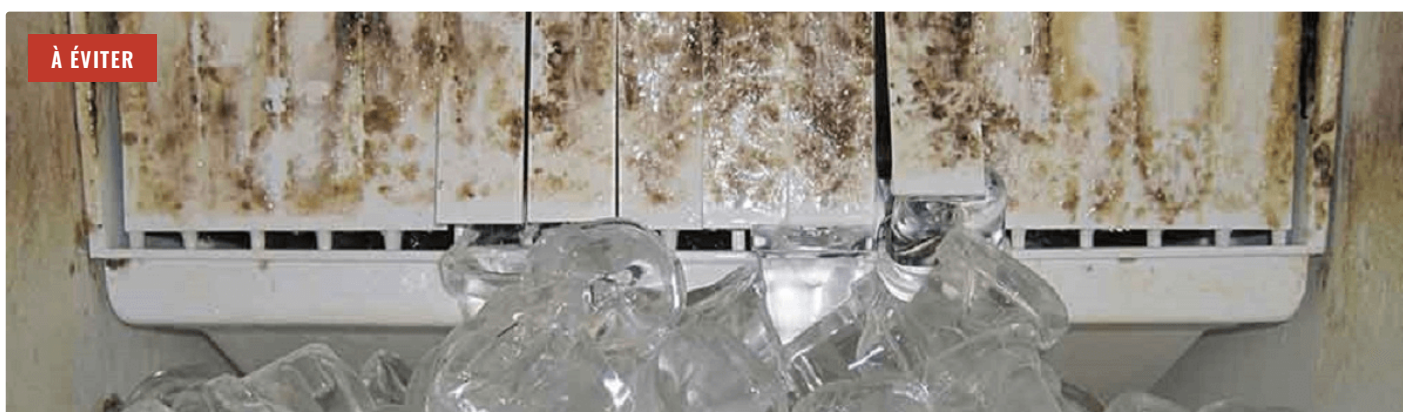
Déflecteur de machine à glaçons — biofilm et moisissures à quelques millimètres des glaçons servis.
